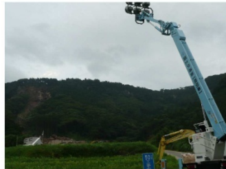
写真 4.3.18 夜間監視用の照明車
